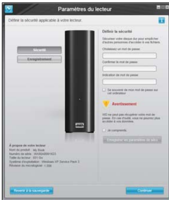
Écran initial Paramètres du lecteur WD SmartWare (Après sélection de Passer la sauvegarde sur étape 7 ou Continuer vers les paramètres à étape 7 en page 12)
